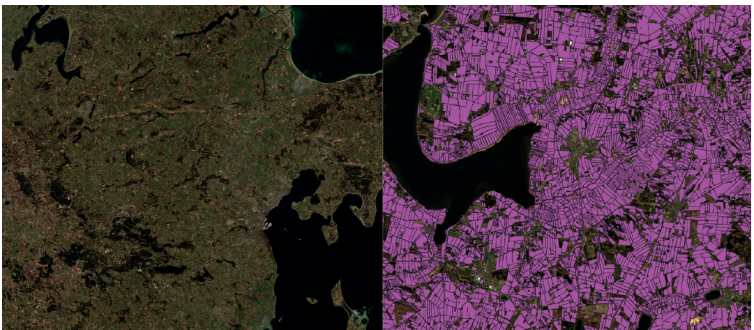
Figur 1. Datagrundlag for marksegmentering. Til venstre ses RGB billedet fra et skyfrit Sentinel-2 produkt. Til højre ses de polygoner vi bruger til at træne vores netværk.
