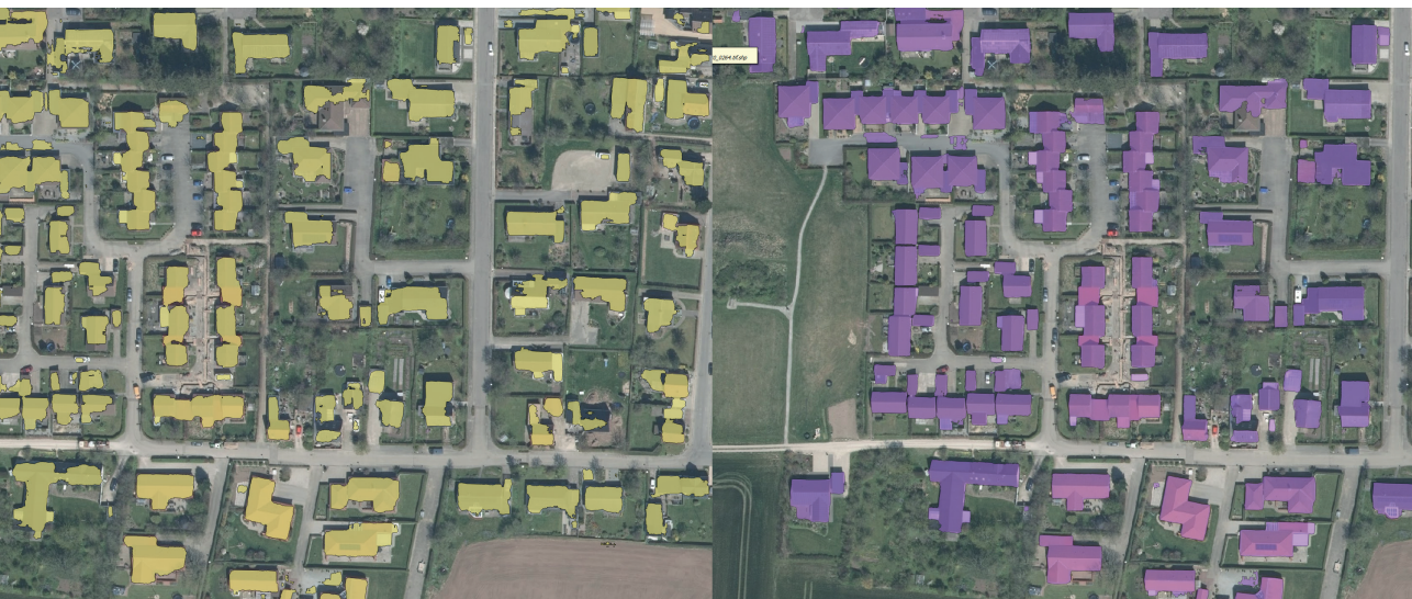
Figur 8. Forfining af bygningssegmentering.
