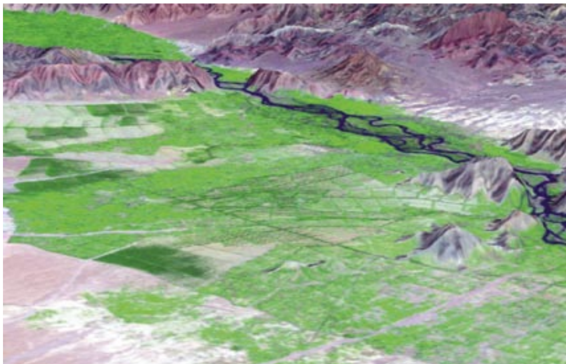
Figur 2: Landsat ETM draperet over en højdemodel for området omkring Jalalabad i Afghanistan. De kunstvandede områder ses tydeligt i grønt på dette rå billede, ligesom konturerne af marker der ikke er vandede kan skues, se eksempelvis øverst til venstre lige bjerget. Se teksten for forklaring af farvenuancer. Illustrationen er fremstillet i samarbejde med det iranske firma Tooss Ab.
