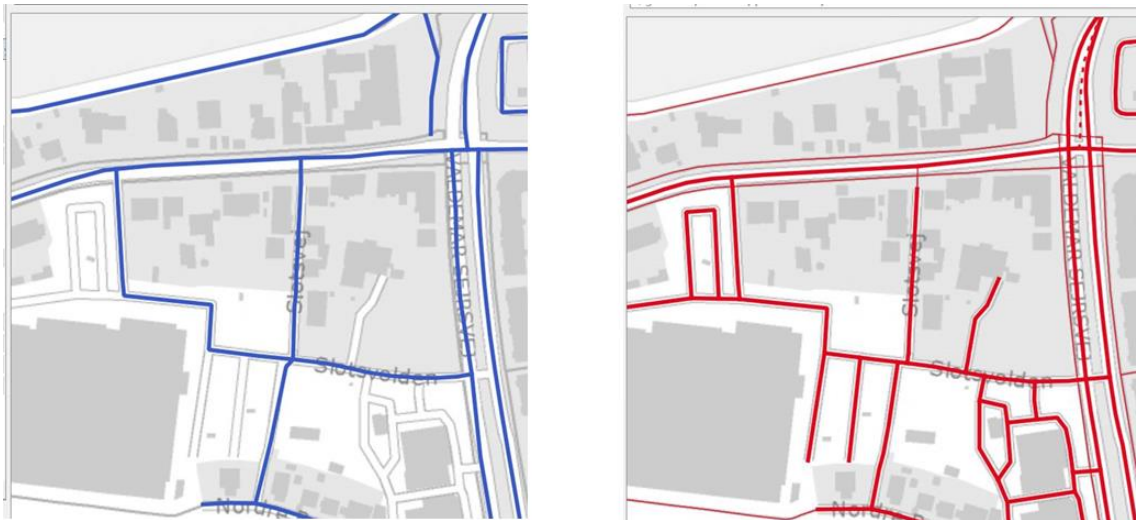
Figur 3: Eksempel på 2 fejl i matchingen mellem vejnettet i vejman.dk og vejnettet i GeoDanmark
