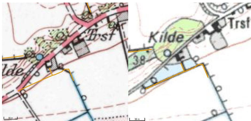
Figur 11. Eksempel på diger beskyttet ud fra kortsignatur, der viser sig at være diger opført omkring et dambrug i perioden 1980-85. Kortet til venstre er målt 1937 og sidst rettet i 1975, medens det til højre er målt 1980, og sidst rettet i 1989, hvilket gør det til det nyeste 4-cm-kort før loven trådte i kraft i 1992, og dermed er digerne omkring dambruget beskyttede. Bearbejdet efter GST & SDFE 2020.
