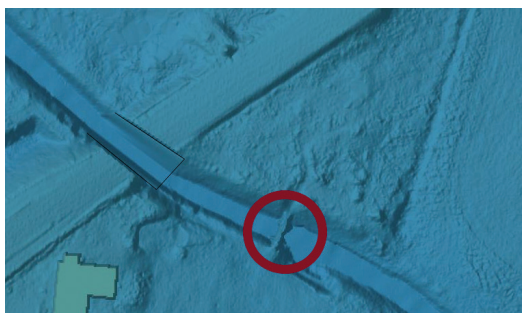
Figur 3. Mindre bro over Værebros Å sydøst for Frederiksborgvej (samme bro som i figur 2). Broens placering er vist med en rød cirkel. Kortgrundlaget er Danmarks Højdemodel fra 2015 med hydrologiske tilpasninger bygget ind i modellen. Ved Frederiksborgvej ses, at der er gennemløb i åen, mens der ikke er gennemløb (hydrologisk tilpasning) ved den lille gangbro. Derved kan vandet ikke strømme under broen, men vil stuve op i stedet.
