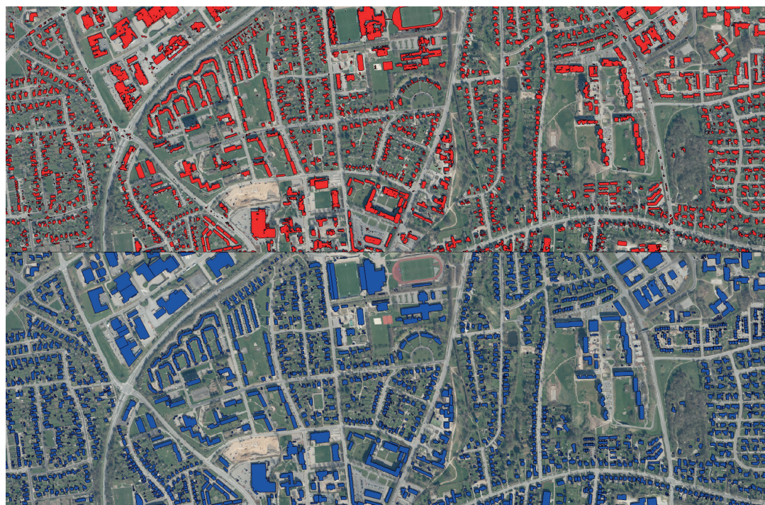
Figur 7. Anvendelse af Deep Learning til segmentering af bygninger (øverste). GeoDanmark polygoner nederst.
