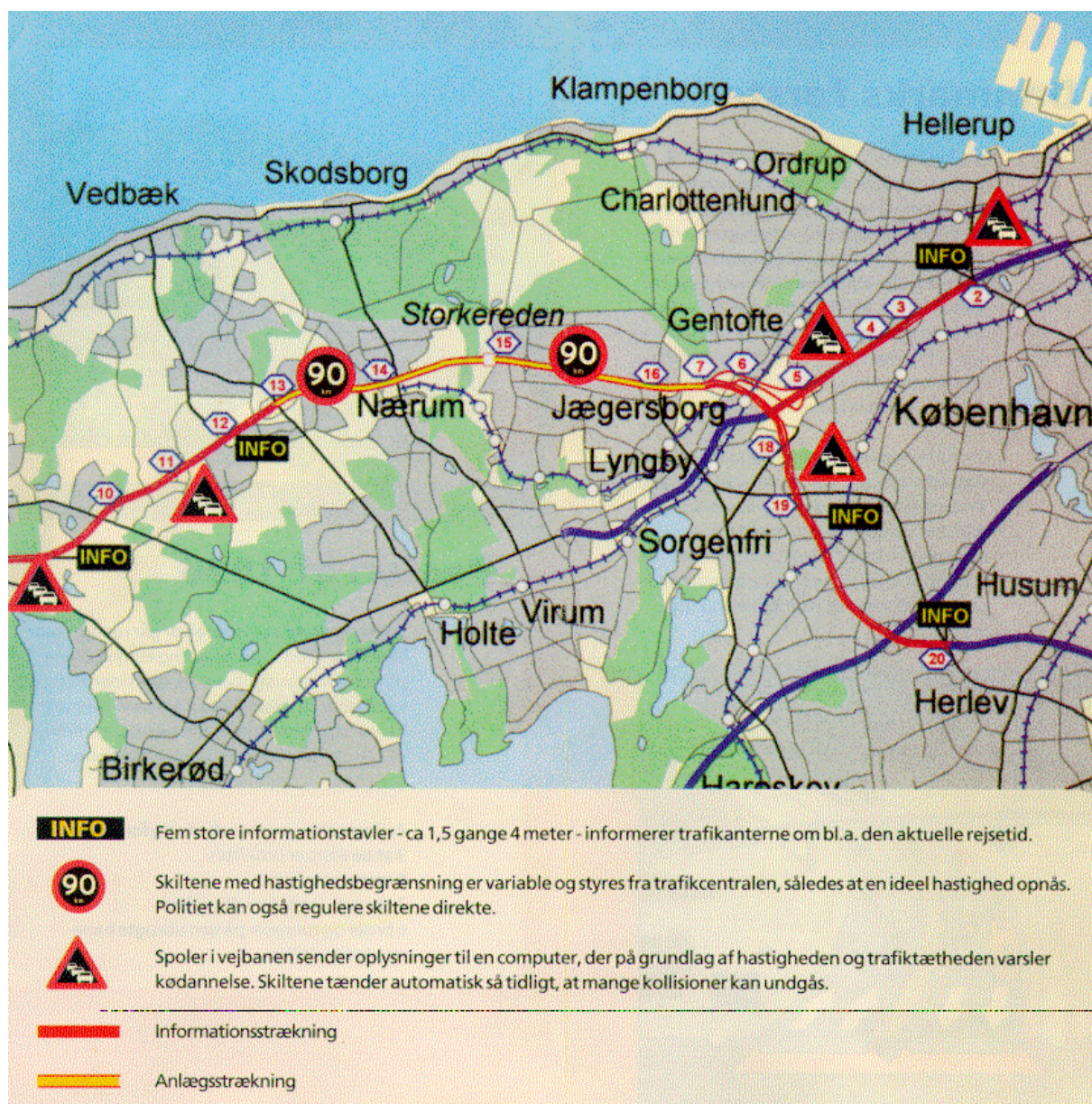
Fig. 2: Principskitse af trafikledelsessystemet på Helsingørmotorvejen
